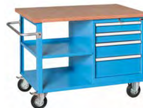
● RXM 120 01 • l. 1200 / p. 700 / h. 895 • Portata 450 kg. Banco da lavoro su ruote (ø 150 mm.) con cassettiera a 4 cassetti (2 H 100 mm.; 1 H 150 mm.; 1 H 200 mm) e piano. Mobile bench on wheels, (ø 150 mm.) with a chest of 4 drawers (2 H 100 mm.; 1 H 150 mm.; 1 H 200 mm) and equipped with a shelf. | Etabli mobile d'atelier (roués diam. 150 mm.) avec caisson a 4 tiroirs (2 H 100 mm.; 1 H 150 mm.; 1 H 200 mm.) et étagère.
