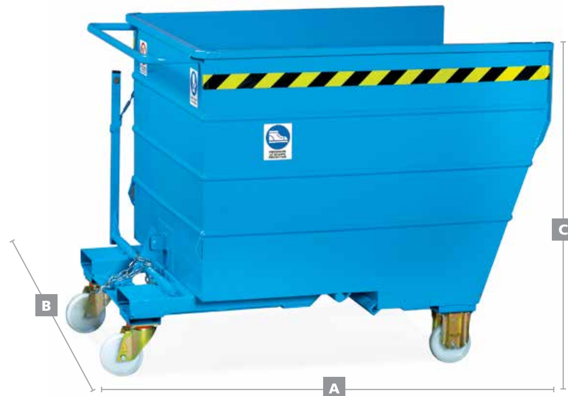
● MG353 Contenitore ribaltabile con ruote Ø 150 (2 fisse e 2 girevoli) portata kg. 1700 - capacità lt. 1000 Tip-up container on wheels Ø 150 (2 fixed wheels and 2 revolving) capacity kg. 1700 - capacity lt. 1000 Benne basculante sur roues diam. 150 (2 fixes et 2 pivotantes). Charge kg. 1700 Capacité lt. 1000 A 1500 (l.) / B 1070 (p.) / C 1210 (h.)
